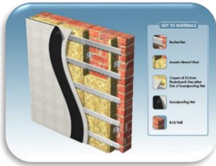
صورة رقم (١٤) (١٦) الصوف الصخري كأحد خامات العزل الصوتي
